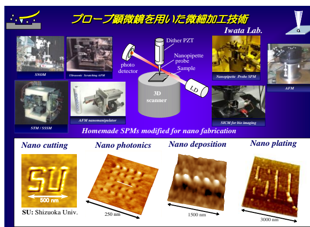
図1 微細加工を目指した走査型プローブ顕微鏡開発
